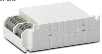
Le contrôleur de luminaire interopérable iLC est conçu pour être utilisé dans l'éclairage public et urbain. Il contrôle des ballasts magnétiques et électroniques équipés d'une interface 1-10 V ou numérique via une communication par courant porteur standardisée basée sur le profil OLC LonMark®.
